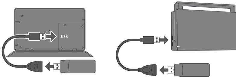
ドック背面のUSBポートを使用する場合や、ドック側面のUSBポートに直接差せない場合は付属のUSB延長ケーブルをお使いください。
